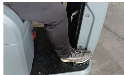
第4步: 握紧方向盘, 轻踩加速踏板, 保持机器平稳行驶。(注意: 清洗时不宜速度过快)
