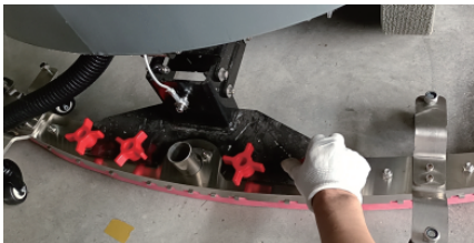
第2步: 将吸水扒固定螺杆穿过三角架孔眼, 使用塑料旋钮拧紧即可。
