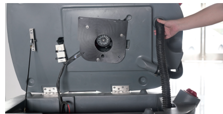
第3步: 将吸污管锥形口插入水箱污水孔, 另端插入吸扒吸水口。
