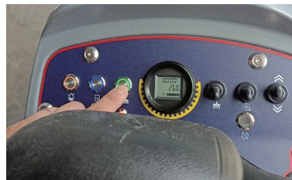
第3步: 启动刷盘开关按钮、吸水电机开关按钮;
