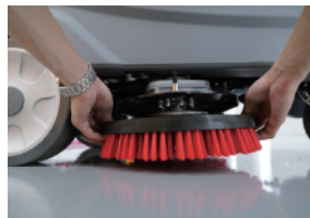
顺时针安装刷盘 逆时针拆卸刷盘
