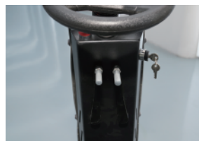
关闭电源 升起刷盘和吸水扒
